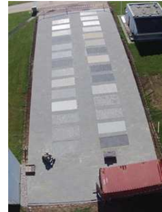
Abbildung 1 Pflastersteinprüfstand des Fraunhofer-Instituts für Bauphysik IBP (Projekt „Untersuchung der Reinigungsfähigkeit innerstädtischer Beläge aus Beton“ [1])
